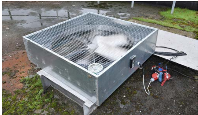
Auf Öffnungen der zu reinigenden Behälter werden Gebläse montiert, die die Luft absaugen und für die Mitarbeiter eine optimale Belüftung sichern.
