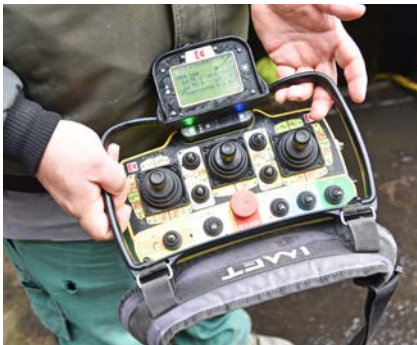
Der Saugbagger wird mit einer Fernbedienung gesteuert.
