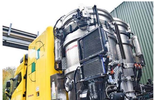
In dem gelben Lkw-Aufbau befindet sich die Pumpeneinheit, die beiden Edelstahl-tanks sind die Filtereinheiten.
